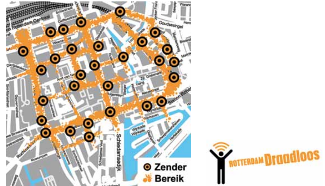
FIGUUR T.2 WiFi-netwerk van Rotterdam Draadloos
